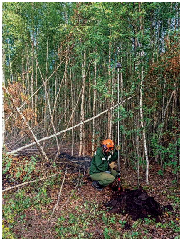
Рис. 2. ИЗМЕРЕНИЕ ПОВЕРХНОСТИ РЕЛЬЕФА И ГЛУБИНЫ ОЧАГА С ПОМОЩЬЮ GNSS-ПРИЕМНИКА
