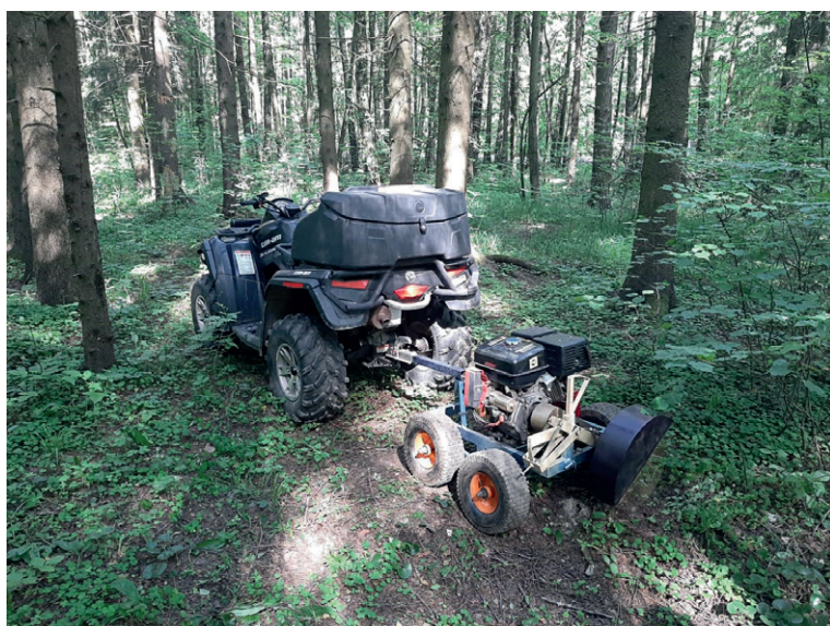
Рис. 1. Мотовездеход с грунтометом, используемый в ходе исследования
