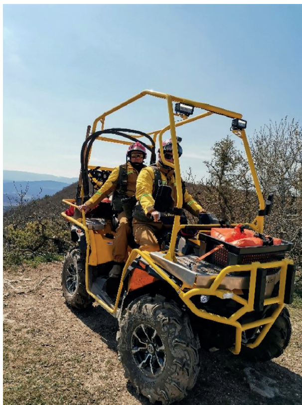
Рис. 3. Мотовездеход, оснащенный каркасом безопасности
