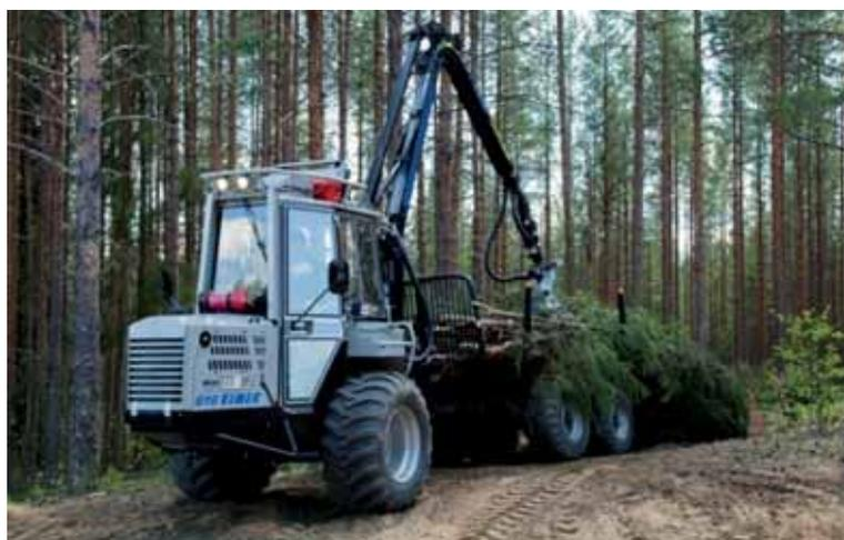
**Рис. 9. Харвардер Vimek 610 BioCombi особо легкого типа (масса – 4,9 т, мощность – 44 кВт, грузоподъемность – 5 000 кг). Фото производителя**
