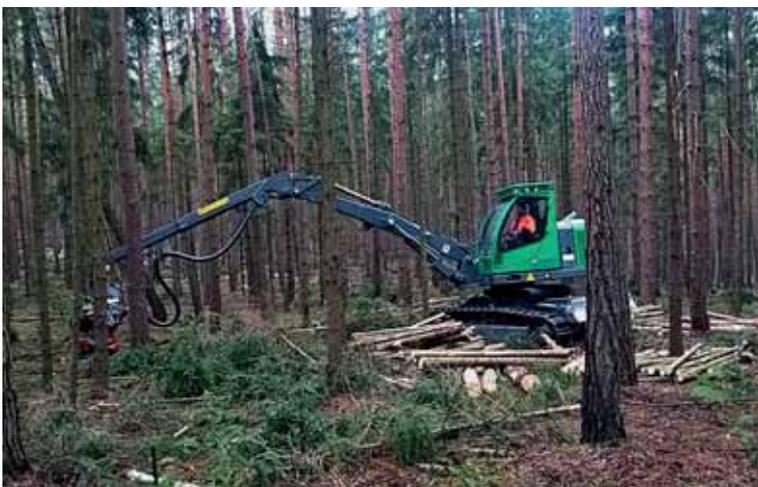
Рис. 8. Гусеничный харвестер Neuson 103 HV легкого класса (фото производителя)
