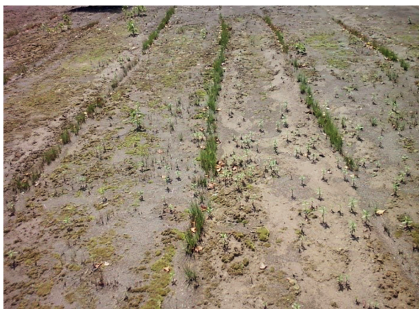
Рис. 4. Результаты эксперимента в производственных условиях с использованием фототрофных бактерий (на поверхности старого хвостохранилища Дальнегорский ГОК)
