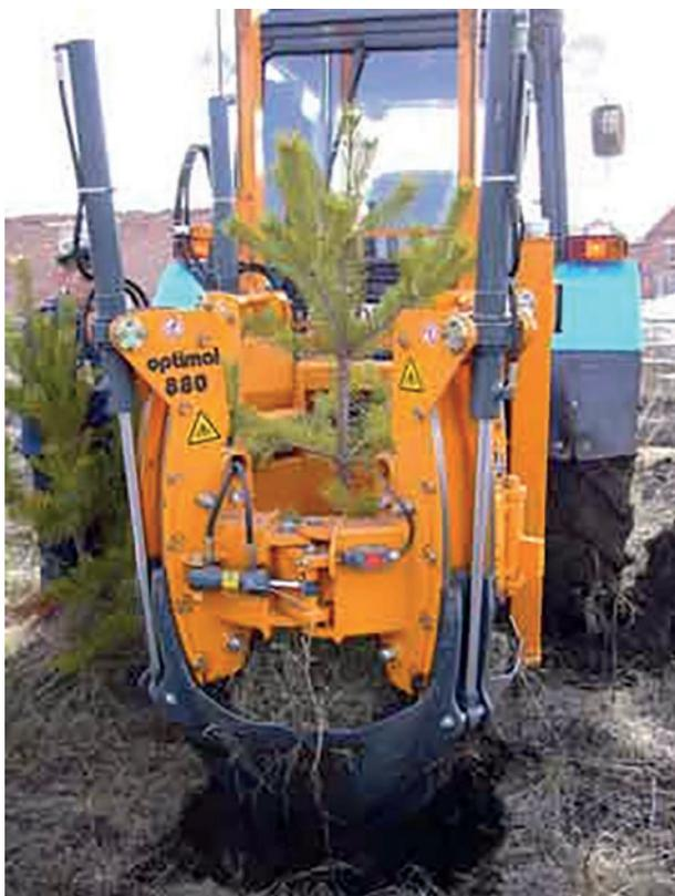
**Рис. 2.** Заготовка посадочного материала с комом почвы
