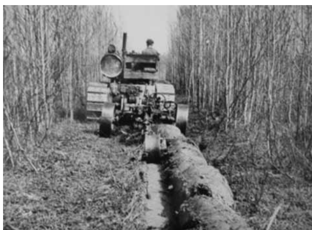
Рис. 4. Кустарниково-болотный плуг ПКБ-56: а – общий вид; обработка почвы ПКБ-56; б – бороздами при коридорной реконструкции; в – бороздами при сплошной реконструкции; г – полосами при полосной реконструкции; д – сплошной вспашкой при сплошной реконструкции
