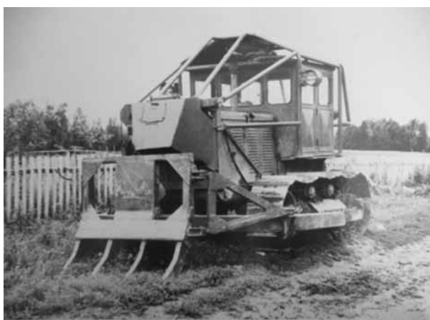
Рис. 2. Корчеватель-собираатель Д-210: а – общий вид; б – уборка пней и корневищ после прохода кустореза
