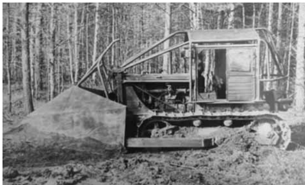
Рис. 1. Кусторез Д-174: а – общий вид; б – расчистка на участке коридорной реконструкции
