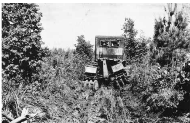
Рис. 5. Уход за культурами сосны культиватором КЛБ-1,7. Полосы подготовлены плугом ПЛП-135, посадку провели лесопосадочной машиной СБН-1. Айшинское лесничество, кв. 12, июнь 1967 г.
