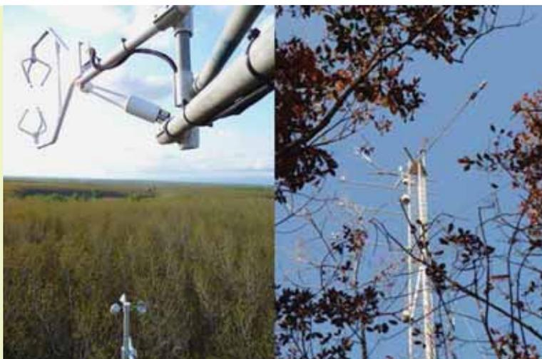
Рис. 2. Общий вид экспериментальной аппаратуры, предназначенной для измерения потоков  $\text{CO}_2$  и углеродного обмена между экосистемой и атмосферой
