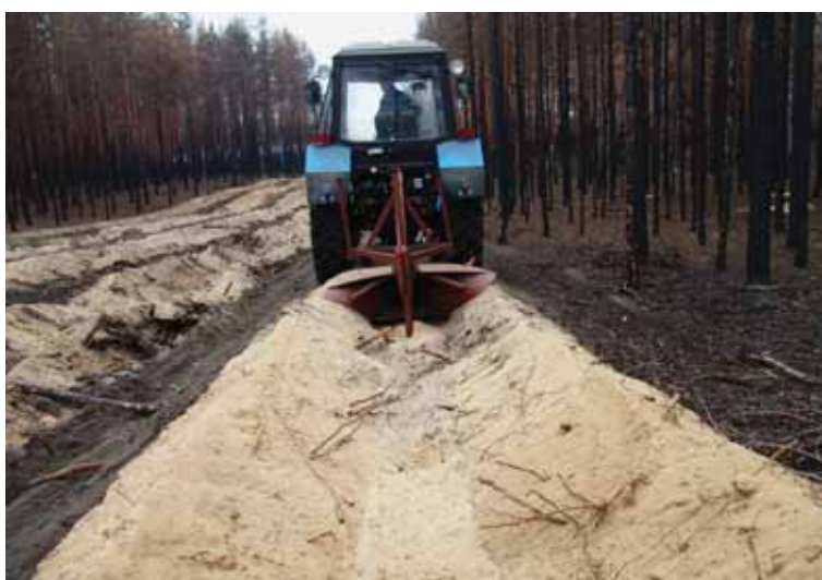
Рис. 3. Плуг-рыхлитель лесной ПРЛ-70 в работе на песчаных почвах (Ростовская обл., Вешенское лесничество)
