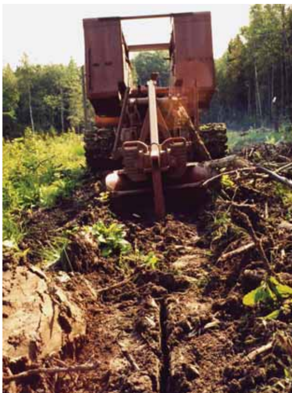
Рис. 2. Плуг-рыхлитель лесной ПРЛ-70 в работе на глинистых почвах (Московская обл., Сергиево-Посадское лесничество)
