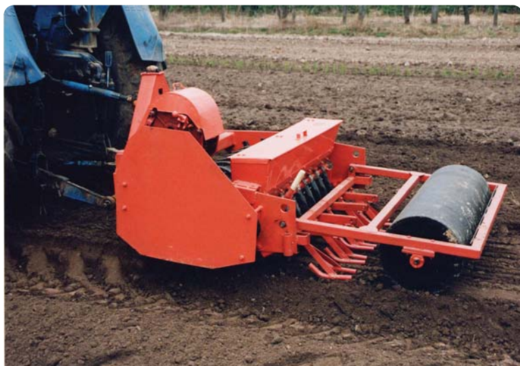
Рис. 4. Сеялка лесная навесная СЛН-5
