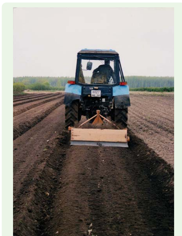
Рис. 3. Машина ротационная бесприводная МРБ-1,6
