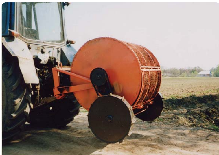
Рис. 5. Мульчирователь сетчатый навесной МСН-1А
