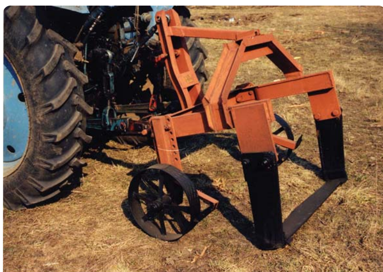
Рис. 7. Приспособление для подрезки корней ППК-1,2
