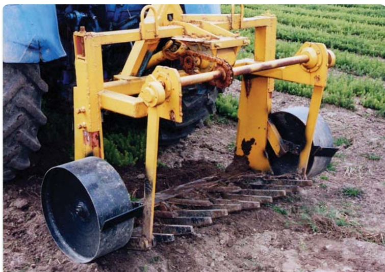
Рис. 8. Машина выкопчная МВ-1,3А
