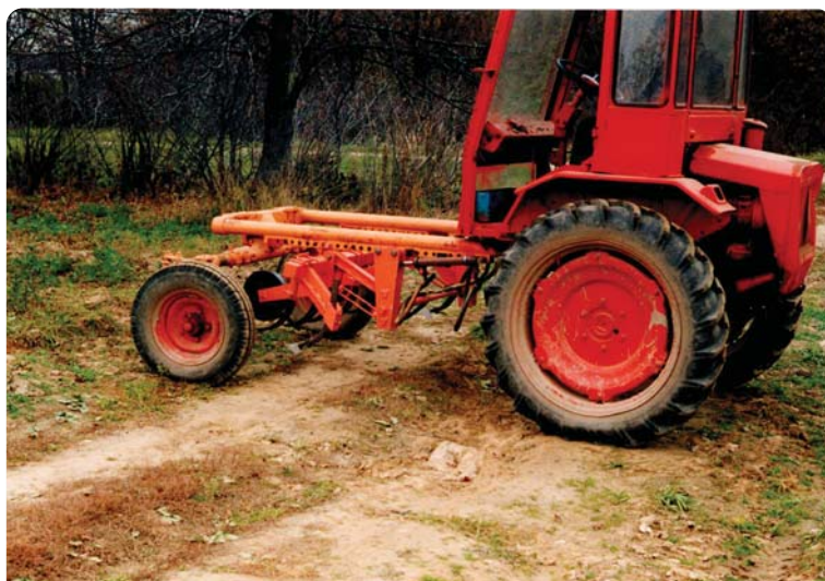
Рис. 6. Культиватор комбинированный для питомников ККП-1,5
