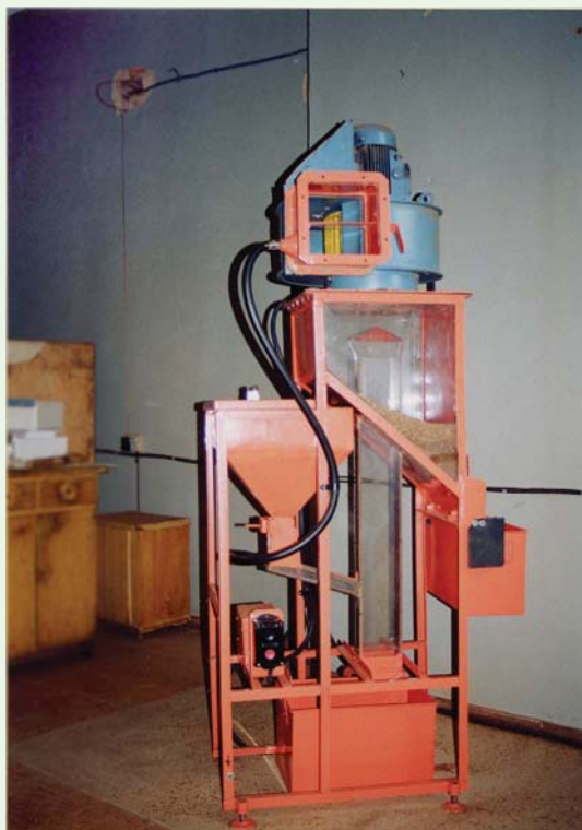
Рис. 1. Пневмосепаратор лесных семян ПЛС-5М
