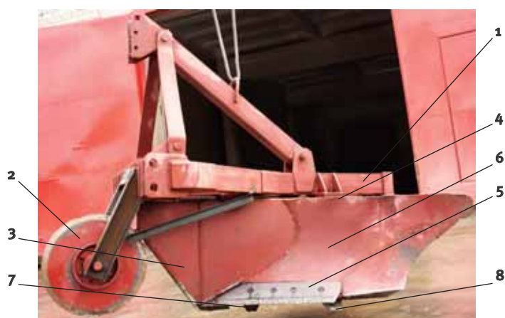
Рис. 2. Общий вид орудия для содействия естественному лесовозобновлению:
